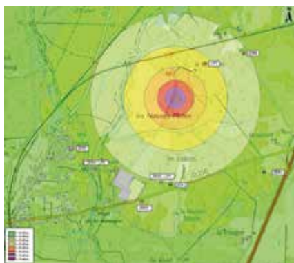
Cartographie du niveau sonore lors d'un essai au sol : l'aéronef est maintenu en position fixe, au sol, au centre de l'aire d'envol à une altitude de 26m (avec le centre de l'aéronef en référence) ;
