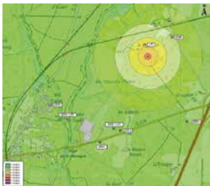
Cartographie du niveau sonore lors d'un essai de portage : l'aéronef est maintenu en position fixe au centre d'une zone dite LEA et des tests de treuillage sont réalisés. L'altitude d'essai est de 75m.
