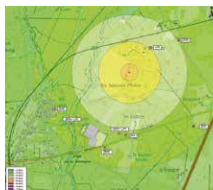
Cartographie du niveau sonore lors d'un vol d'essai : l'aéronef est simulé en position fixe à une altitude de 243m (800ft) au-dessus de l'aire d'envol
